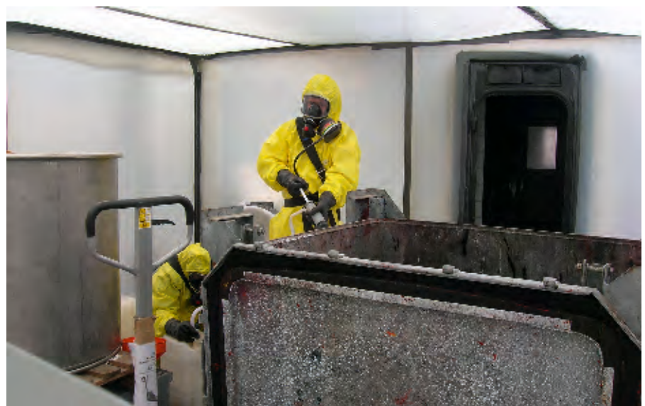
Mit der Handpumpe befördert das Duo die hochgiftige Flüssigkeit aus dem beschädigten Fass in die bereitgestellten Kanister. Abschließend wird das Fass mit Natronlauge gespült, um es komplett zu reinigen. Danach gelangt die Lauge ebenfalls in Kanister.
